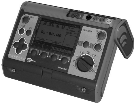
Bild 9.22 Digitales Erdungsmessgerät, automatisch messend, „MRU-200“ (Foto: Somel [3.38])
