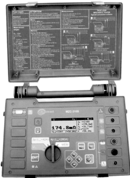
Bild 6.5 Schleifenimpedanzmessgerät MZC-310S, Fa. Sonel, für die genauere Messung von Netzimpedanzen
